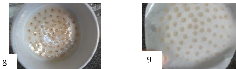
Figura 8. Impurezas retiradas da gordura residual com o auxílio da bomba de vácuo; Figura 9. Impurezas retiradas do sebo suíno com o auxílio da bomba de vácuo
