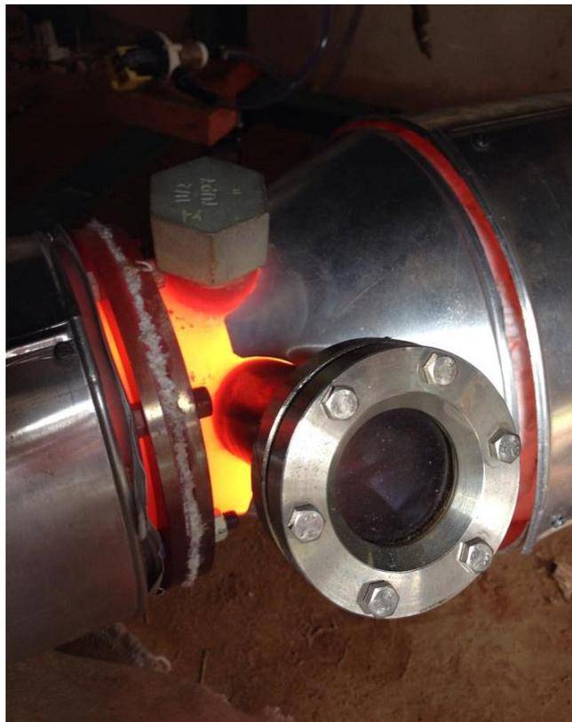
Figura 4. Câmara de combustão do sistema de gaseificação.
