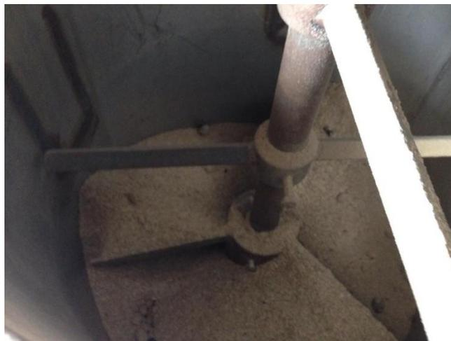
Figura 5. Misturador do silo de alimentação.
