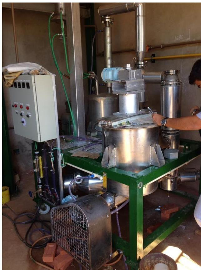
Figura 6. Sistema de gaseificação em instalação
