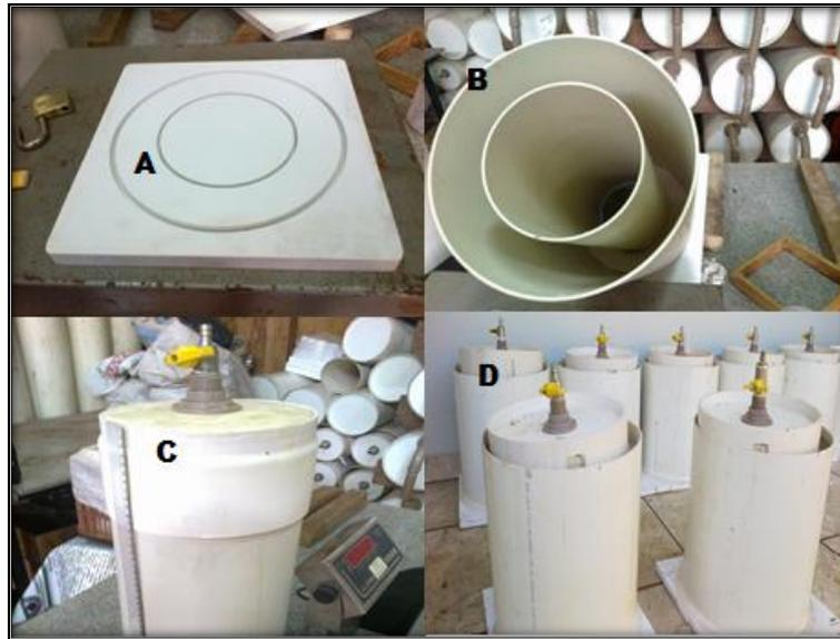
Figura 1 - Biodigestores de Bancada de Batelada. A) Placa de PVC. B) Câmara de digestão e Selo d'água. C) Gasômetro. D) Biodigestores em operação.
